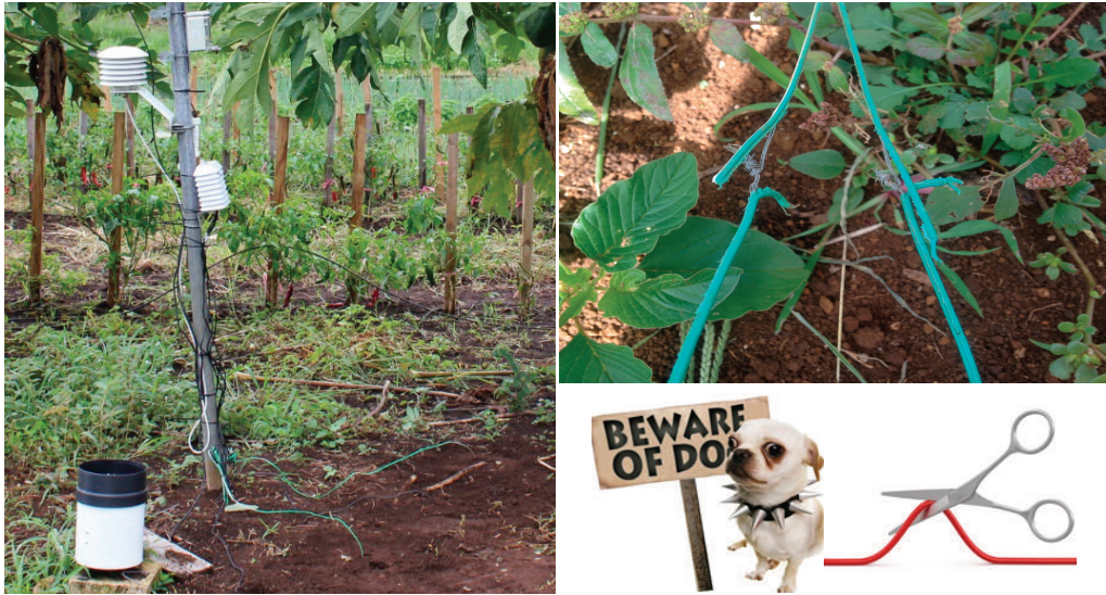
그림 4.27. Nishi Farm의 토양수분센서 설치 전경과 케이블 손상 상태
