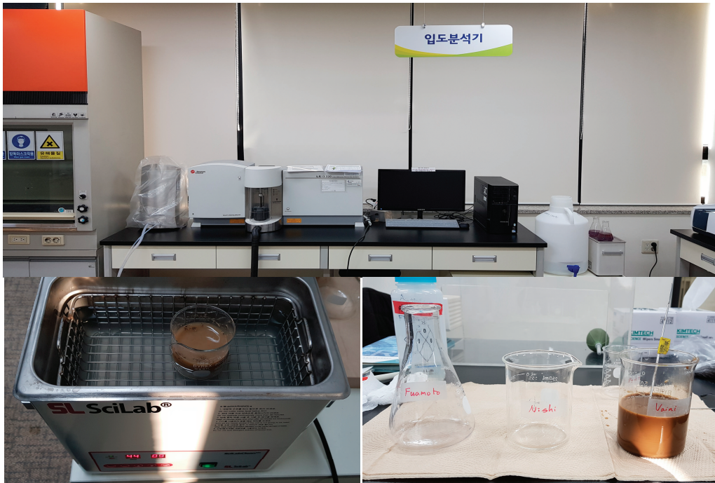
그림 4.28. 토양에 대한 입도분석 시험
