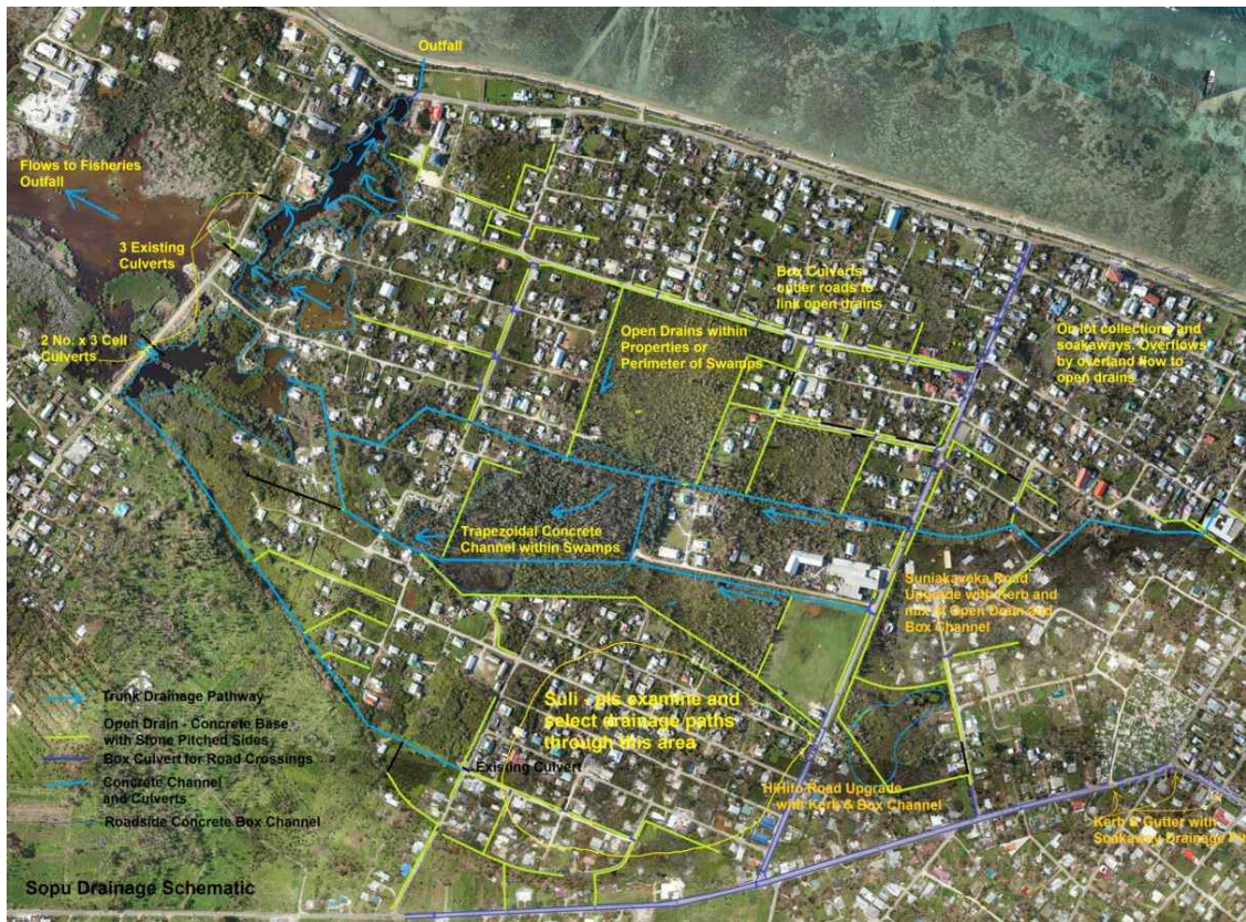
그림 3 GCF Proposal에 계획 중인 Sopur Drainage System schematic (Nuku'alofa, Tonga)
